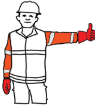
1. Nosta puomia Käsivarsi sivulle ojennettuna, peukalo ylöspäin
