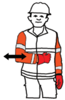
9. Käynnistä pumppu Lisää pumppaustehoa Sivuttaisliike kyynärvarrella
