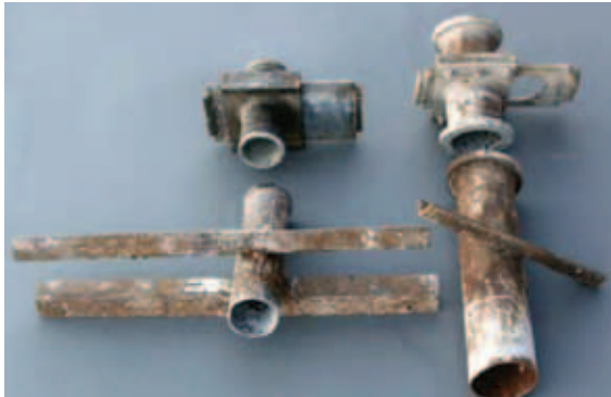
Valuputki ja sulkuventtiileitä
