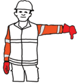
2. Laske puomia Käsivarsi sivulle ojennettuna, peukalo alaspäin
