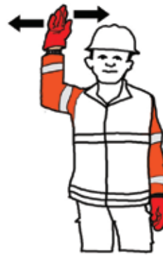
12. En ymmärtänyt Käsivarsi kohotettuna Sivuttaisliike käsivarrella
